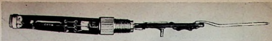
Bild 33. Innenaufbau des Tastkopfes
